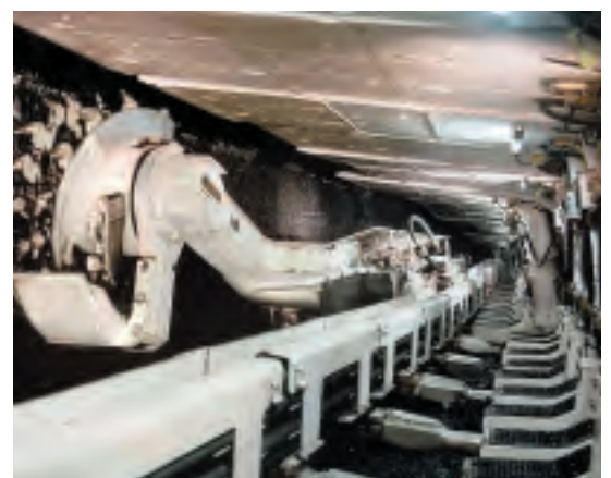
La extracción por tajos largos supone la extracción completa del carbón de una sección de la veta o “cara” utilizando rafadoras-cargadoras mecánicas. Fotografía cedida por cortesía de Joy Mining Machinery.
