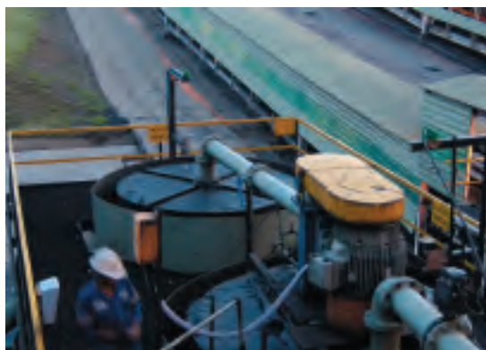
Las celdas de flotación de Goedehoop Colliery se utilizan para la preparación del carbón. Fotografía cedida por cortesía de Anglo Coal.
